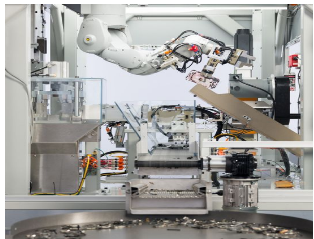
그림7 | 애플 로봇 Daisy, iPhone을 분해를 통해 소재를 재활용
